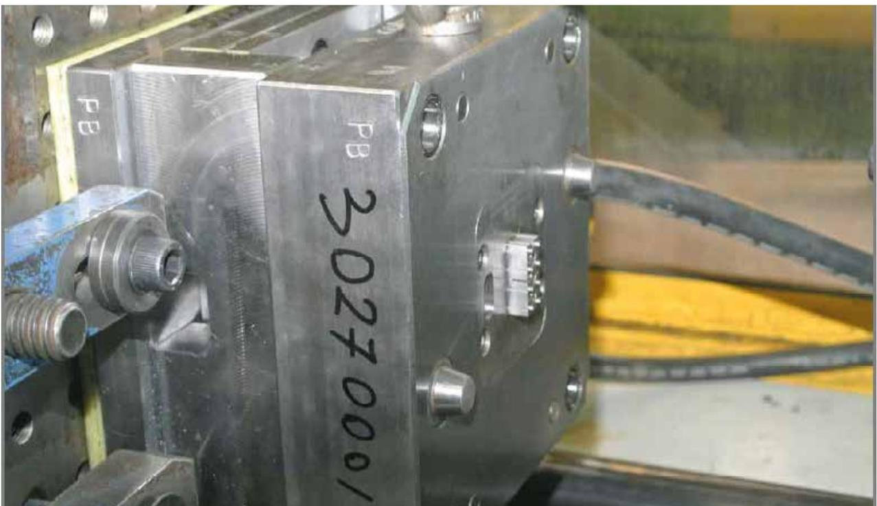
Code: 15010 dettaglio laterale stampo mattoncino tipo quello delle costruzioni LEGO
